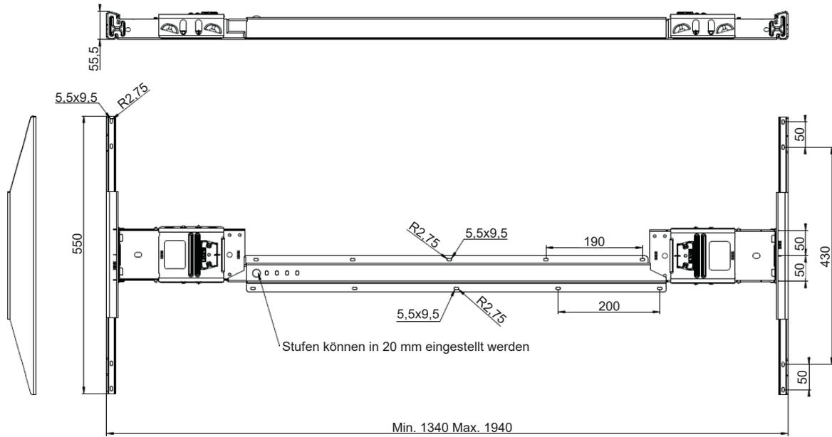
Abbildung 4 Kick & Click Adjustable (Standard) Abmessungen in mm
