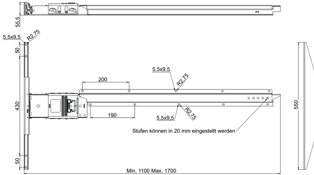
Abbildung 8 Kick & Click Kit für drittes Bein Abmessungen in mm
