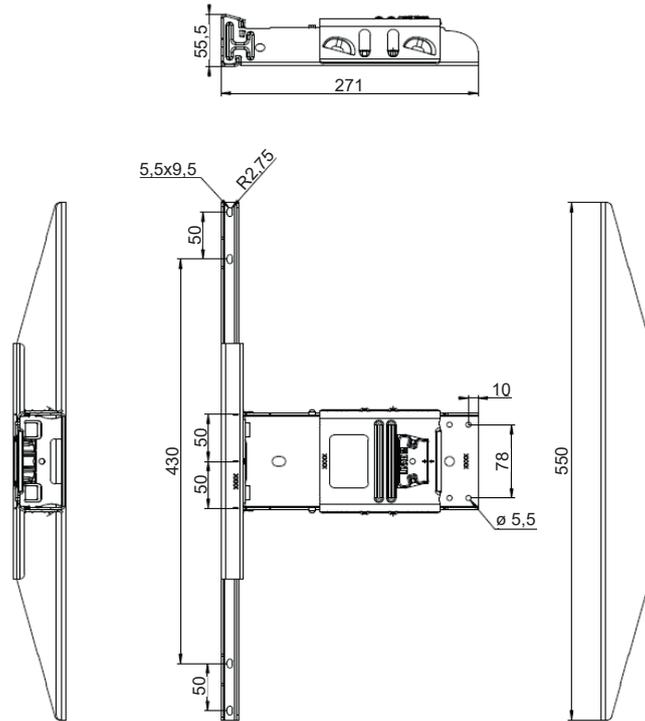
Abbildung 7 Kick & Click Base Abmessungen in mm
