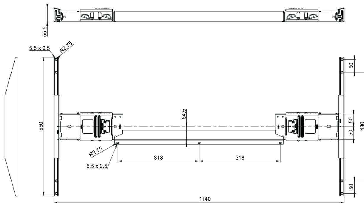
Abbildung 2 Kick & Click Fixed Abmessungen in mm
