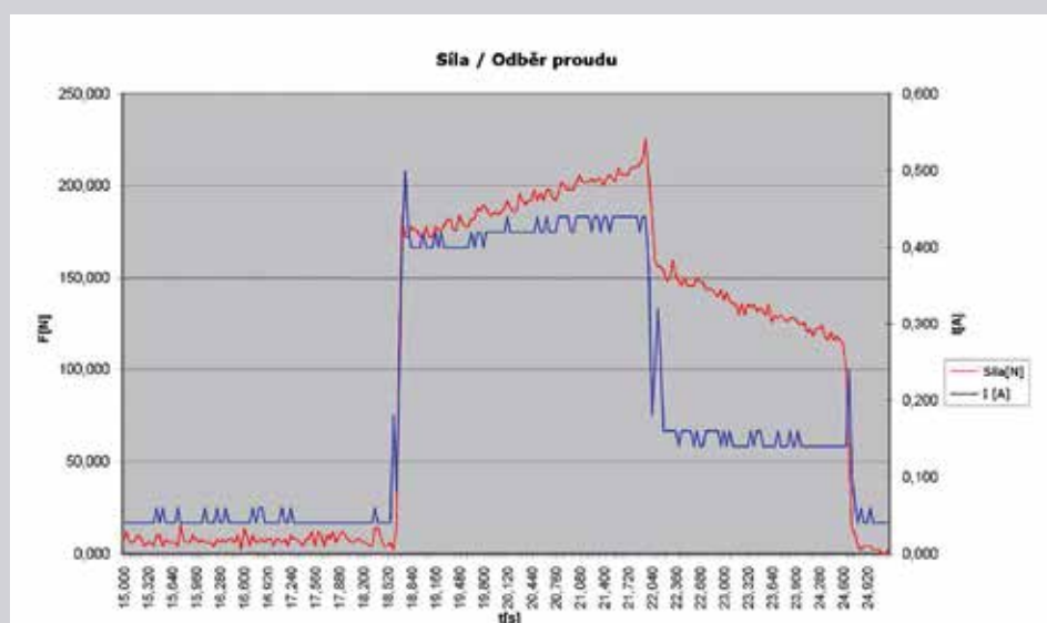
Porovnání odběru proudu v poměru k síle elektrického lineárního pohonu
